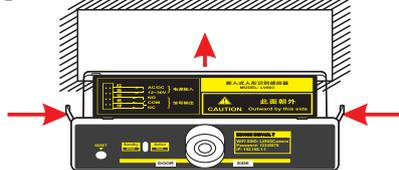
夹紧两侧的金属弹片，将感应器置入安装孔内，按照接线图接线去自动门机。
