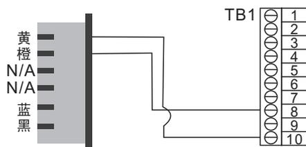
注：6PIN排线中的橙、黄色线分别与控制器的TB1的端子8、端子10相接如图。
